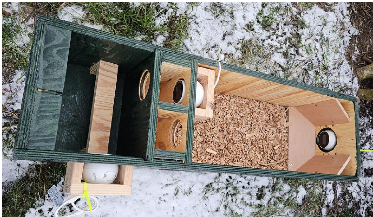
Figuur 4: Van links naar rechts: zijcamera, de camera die van binnen op de invliegopening staat gericht en de camera die registreert wat er zich in de broedruimte afspeelt.
