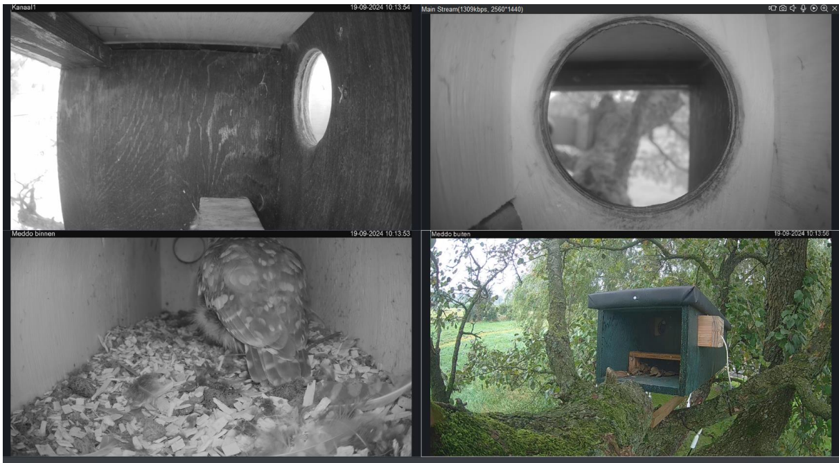
Figuur 1: Het beeld van de verschillende camera's: linksboven de zijcamera, rechtsboven de camera die op de invliegopening staat gericht, linksonder de camera in de broedruimte en rechtsonder de buitencamera.
